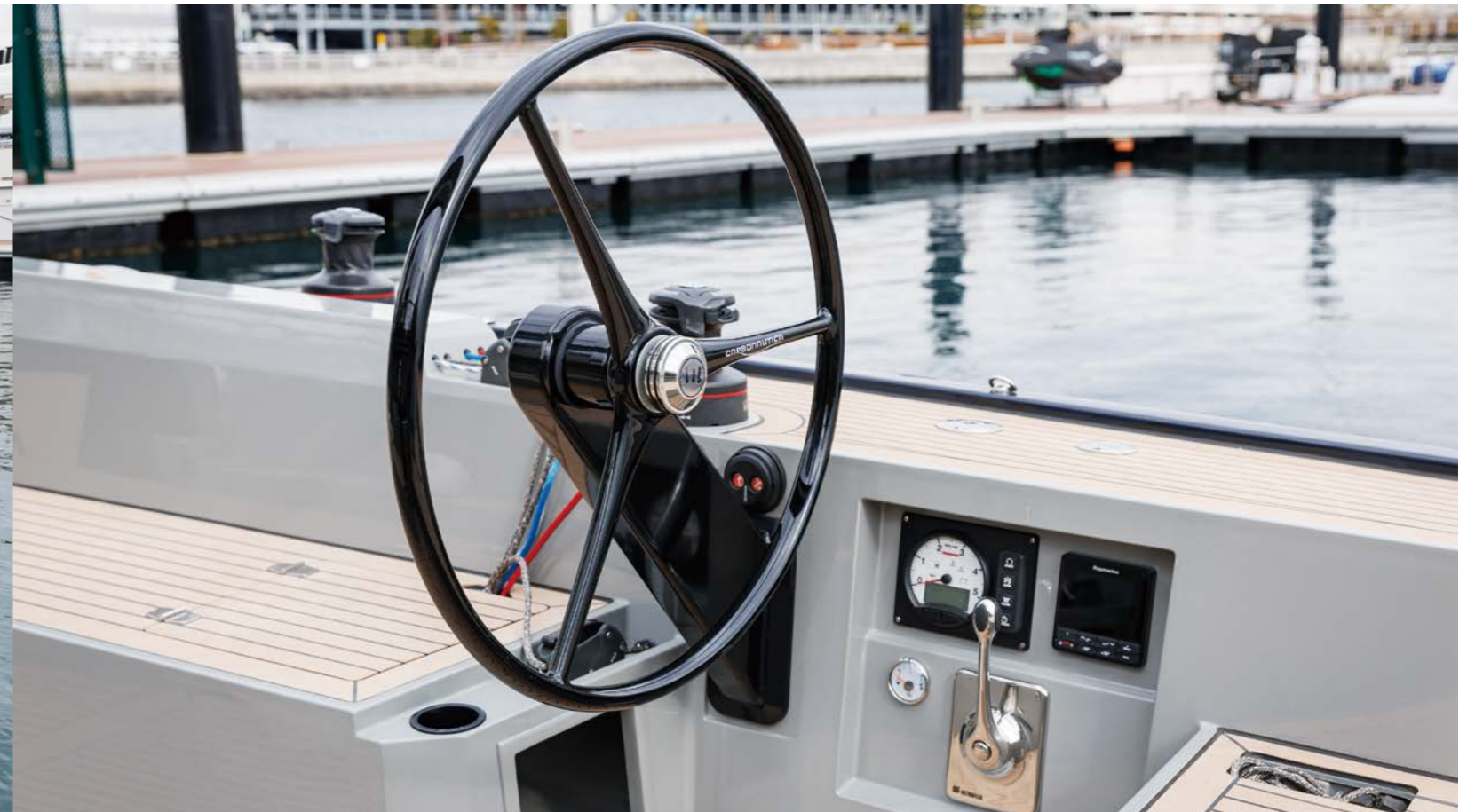
ラット(ステアリングホイール)の側面にはメーターパネルやスイッチ、エンジンコントロールレバー。すぐ前には電動ウインチとコントローラー。セーリング関係のシート類やストッパーも集約され、移動することなくシングルでもセーリングすることができる。ポップアップクリートもモダンで美しい。
