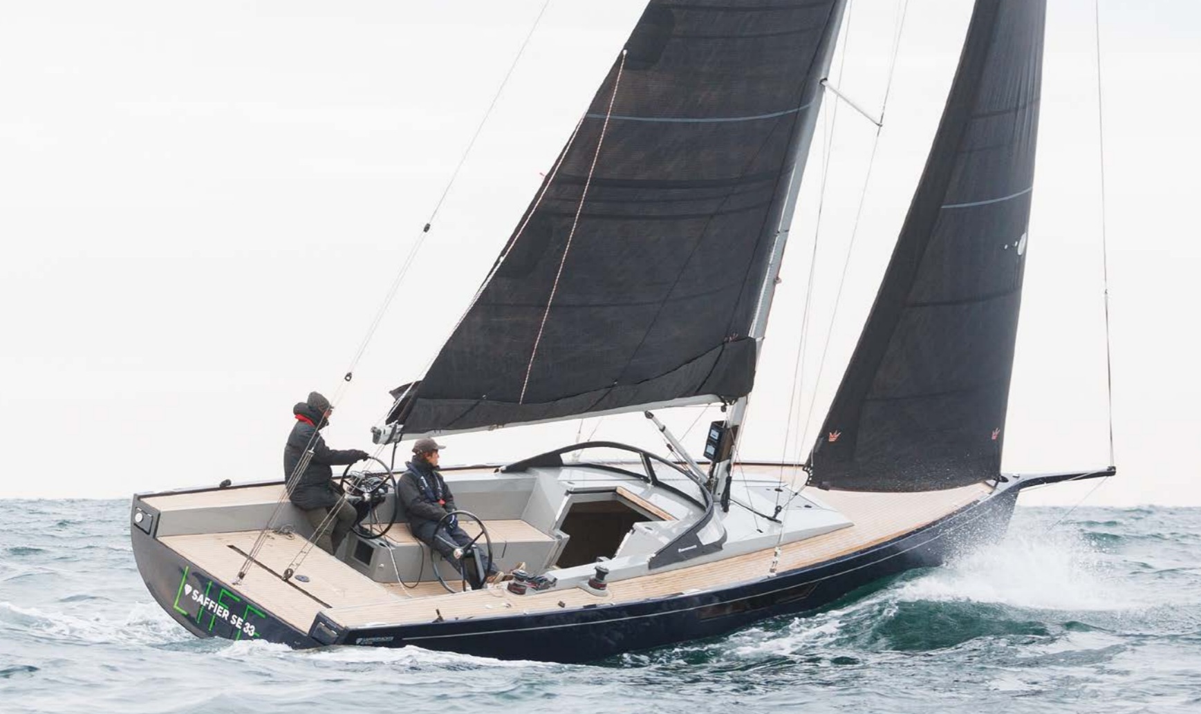
朝まで続いた強風の影響で荒れた海面。風速5~8m/sのガスティな風の中、6~7ノットで快速セーリング。ブローが入るオーバーセール時でも、直進性は高く、ラットに負荷がかかることはない。ヒールを強めるが、腰が強くマイルドな挙動。ラダーが抜けることもなく、安定感と安心感のあるセーリングを楽しむことができる。
