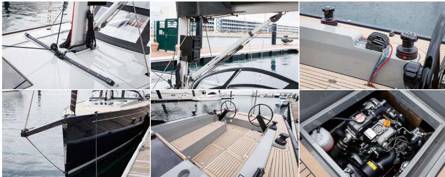
セルフタックシステム、ブームバンク、電動ウインチに手元のシートストッパー。コードゼロ用のバウスプリットやツイソラット、低ノイズのエンジンとセールドライブなど、シングルハンドでも安全で快速、そして快適にセーリングを楽しめるような儀装が細部にわたりデザインされている。
