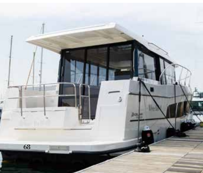
バウもスターンもほぼ垂直。キャビンは前後に大きく、フロントウィンドシールドも垂直。スタイリングは、全長を一杯生かした長方形のBOXに近づき、広いキャビン空間を確保。デザインは、ハウスボートやナローボートに近づいている。最新トローラー「Escape 1150 Voyage」は、低速では低燃費、プレーニングをして20ノット以上のスピードで走ることもできる、移動できる水上コテージ。
