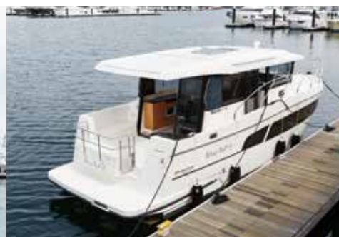
バウもスターンもほぼ垂直。キャビンは前後に大きく、フロントウィンドシールドも垂直。スタイリングは、全長を一杯生かした長方形のBOXに近づき、広いキャビン空間を確保。デザインは、ハウスボートやナローボートに近づいている。最新トローラー「Escape 1150 Voyage」は、低速では低燃費、プレーニングをして20ノット以上のスピードで走ることもできる、移動できる水上コテージ。
