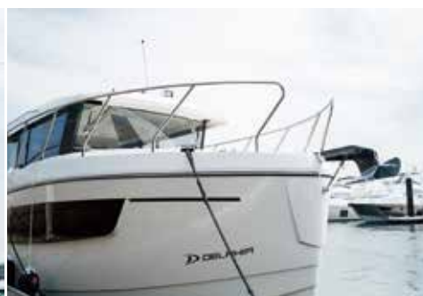
バウもスターンもほぼ垂直。キャビンは前後に大きく、フロントウィンドシールドも垂直。スタイリングは、全長を一杯生かした長方形のBOXに近づき、広いキャビン空間を確保。デザインは、ハウスボートやナローボートに近づいている。最新トローラー「Escape 1150 Voyage」は、低速では低燃費、プレーニングをして20ノット以上のスピードで走ることもできる、移動できる水上コテージ。
