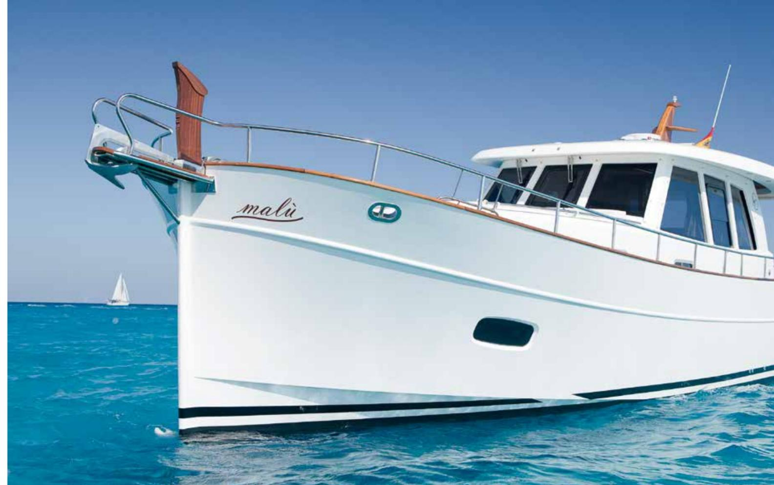
垂直のステムはそのままに、大きく変化したボトムデザイン。ハウからスタンまで直線的に入っていたフルキールが、中央付近だけに限定された新時代のキール。直進性が高く、ソフトライド、プロペラが守られるメリットを残しながら、追い波時のローリングもなくなり、回頭性が向上している。
