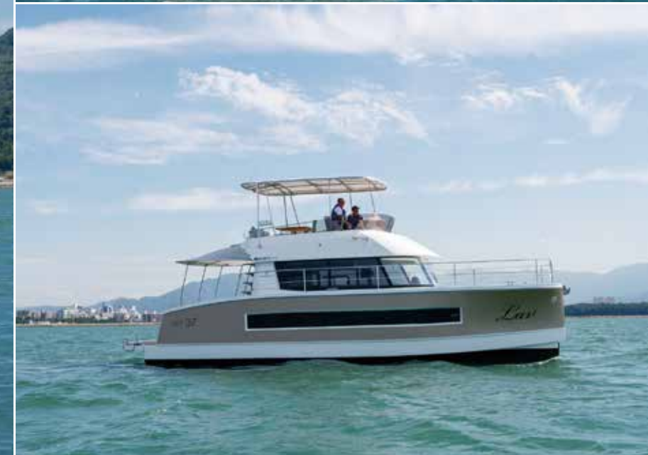
37フィート艇ながら5.15mというカタマランならではの超ワイドビーム。緩やかにカーブした美しいシアライン、垂直に立ち上がったバウシステムも特徴的だ。
