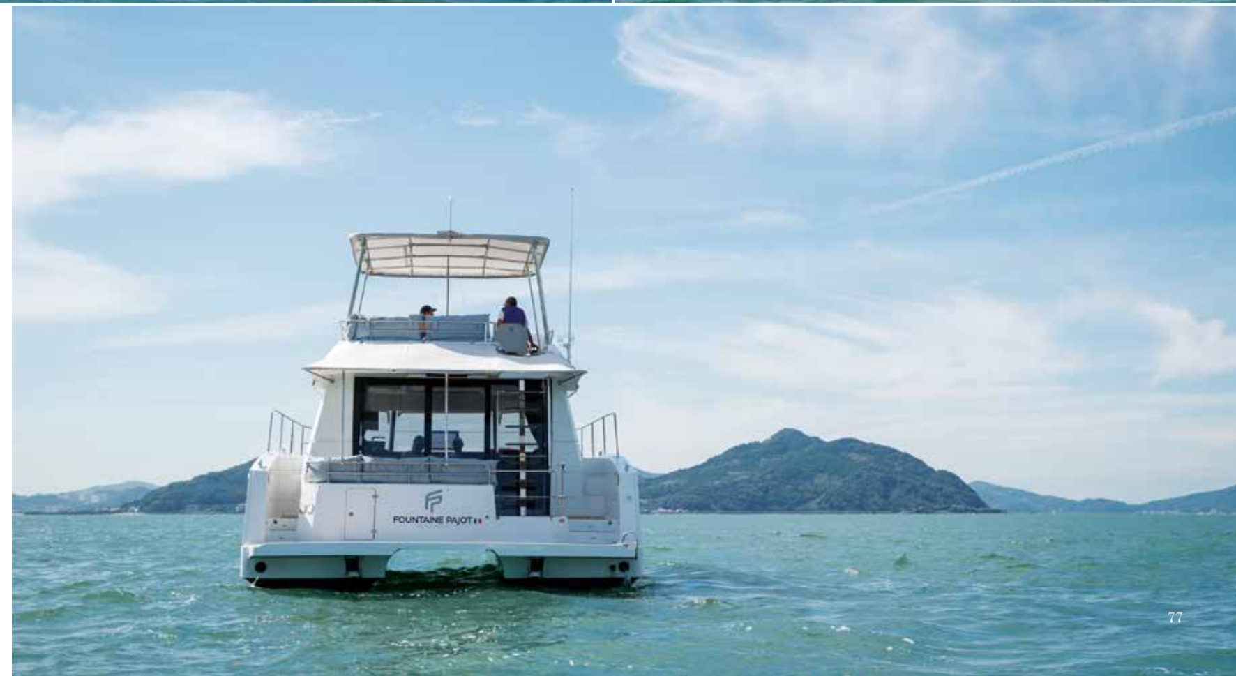
37フィート艇ながら5.15mというカタマランならではの超ワイドビーム。緩やかにカーブした美しいシアライン、垂直に立ち上がったバウシステムも特徴的だ。
