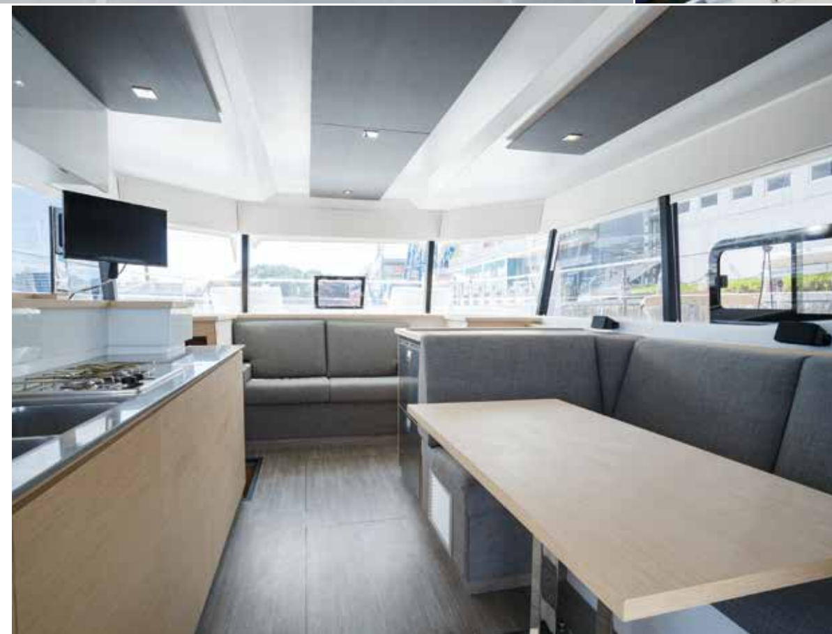
まさに360度のパノラマビューと言ふにふさわしい視界が確保されたメインサロン。高さもあり、とても明るい雰囲気。右舷と船首側にソファを配置、左舷に大型ギャレーカウンター。ギャレーには150Lの引き出し式冷蔵庫、ダブルシンク、3バーナーコンロなどが備わる。船首側にはソファの代わりにロアヘルムステーションも設けられる。
