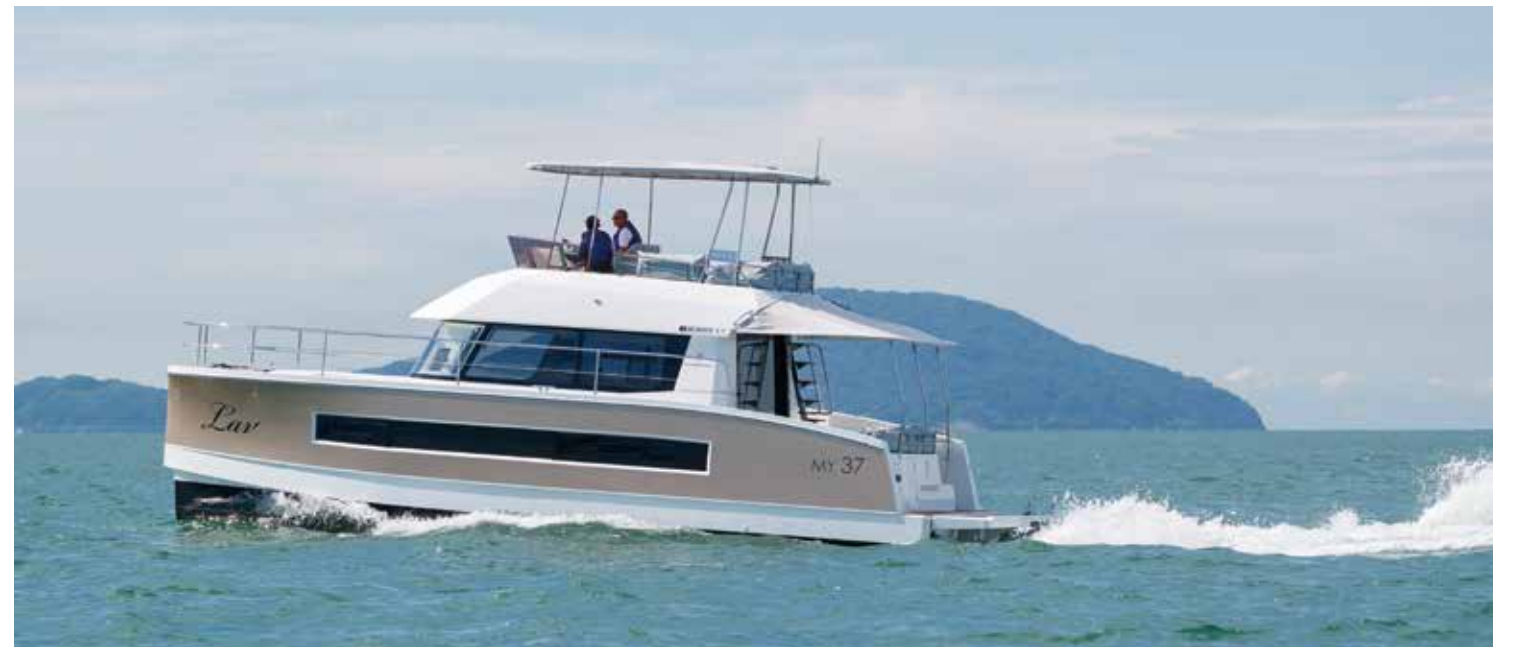
仕様やコンディションによっても変わるが、ビルダー発表の参考値ではトップスピードは21ノット。そしてエコクルーズモードの約7.5ノットではリッター1マイルの低燃費を実現。理論上の航続距離は1,200マイルに及ぶ。
