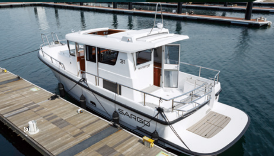
ウォークアラウンド&両舷スライドドアのパイロットハウスというフィンポートスタイル。広々としたサイドデッキが歩きやすい。スライディングルーフの構造は従来モデルから変更され操作感も軽くなった。エンジンはVOLVO PENTA D6-340馬力を1基。D4を2基搭載可能なスペースのため、メンテナンス性は非常に良好。広いスライディングプラットフォームにはインスペクションハッチがあり、プロペラのトラブルにも対応しやすい。
