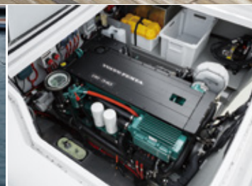
ウォークアラウンド&両舷スライドドアのパイロットハウスというフィンポートスタイル。広々としたサイドデッキが歩きやすい。スライディングルーフの構造は従来モデルから変更され操作感も軽くなった。エンジンはVOLVO PENTA D6-340馬力を1基。D4を2基搭載可能なスペースのため、メンテナンス性は非常に良好。広いスライディングプラットフォームにはインスペクションハッチがあり、プロペラのトラブルにも対応しやすい。
