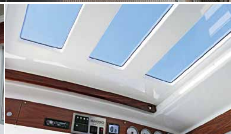
非常に見晴らしの良いフロントウィンドウ。高速でのターン時も十分な視界が確保されている。逆傾斜により、陽光の差し込みが少ないのも特徴だ。パイロットハウス天井は可動式のスカイライトハッチ。全開すれば心地よい風を受けながら走りを楽しめる。
