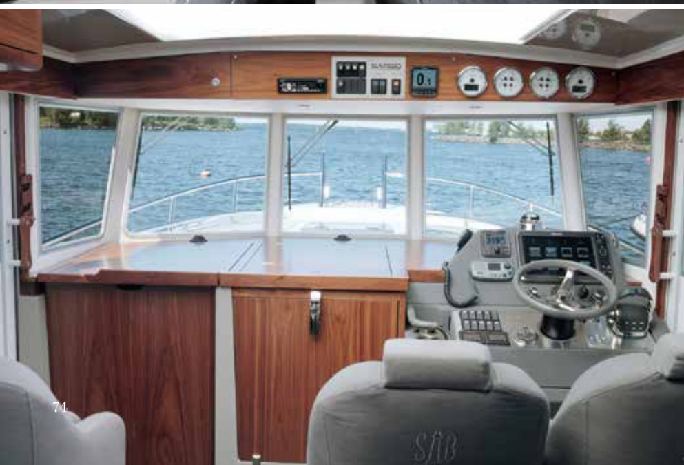
非常に見晴らしの良いフロントウィンドウ。高速でのターン時も十分な視界が確保されている。逆傾斜により、陽光の差し込みが少ないのも特徴だ。パイロットハウス天井は可動式のスカイライトハッチ。全開すれば心地よい風を受けながら走りを楽しめる。
