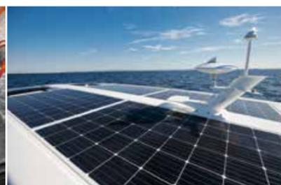
床下にはYANMAR 8LV370エンジンが潜んでいる。ハイブリッド仕様ではないため床下は広々。ルーフにはソーラーパネルが貼られ1.2kwの電力を発電しバッテリーに供給している。
