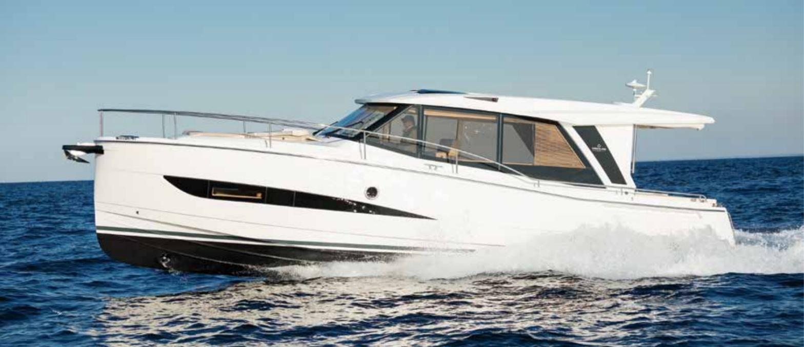
3,200rpm-21.1 ノット-54.1L/h、3,400rpm-22.8 ノット-63.1L/h、3,600rpm-25.2 ノット-73.4L/h。25 ノットでの安定感に心強いものがある。このハルなら2基掛けであと10ノットオーバーも可能だろうとほくそ笑んでいた。エココンシャスな GREENLINE に似合わない思い付き、即払拭した。オートパイロットでヘディングを決め気ままにクルージングを楽しむ、それがいい。
