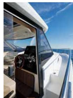
ウィンドウはフロントから両サイドにかけワイド&ビミー、採光豊かなグリーンエリアが広がる。キャビンのルーフはフロントから後部に行くほどビームいっぱいになり、サイドピラーでガンネルと結合し、モダンなデザインにクラシカルな雰囲気を導き出している。高いガンネルとサイドピラーはウォークアラウンドのキャットウェイをエレガントに演出している。更にルーフはアフトコクピット
