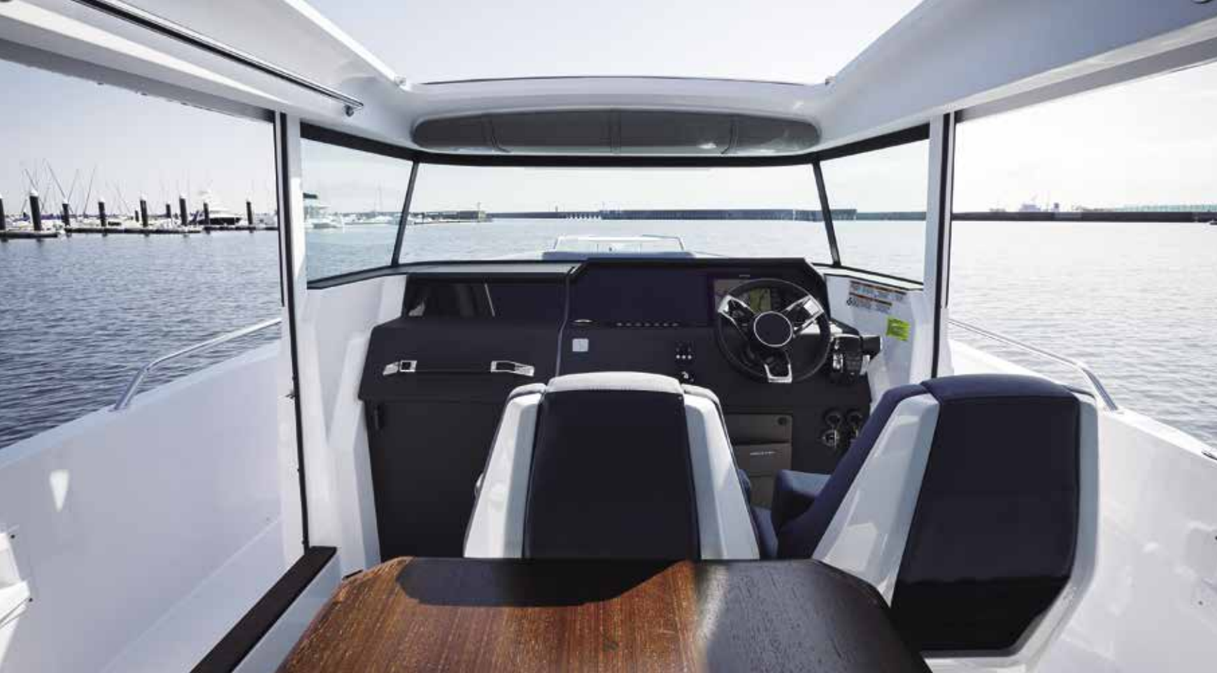
両舷のサイドスライドドアは意義深い。ステアリングを離してサイドデッキに出て離着岸の作業に移れる機敏さ、スキャンジナビアンスタイルだ。2脚のヘルムシート、整然としたコンソール。ISOTIAの6スポークステアリング、正面にSIMRADのGPSマルチディスプレイ、ステアリング右手にスロットルコントロールレバー、左にパウラスターレバーが屈並ぶ。そしてこのパノラマ視界！
