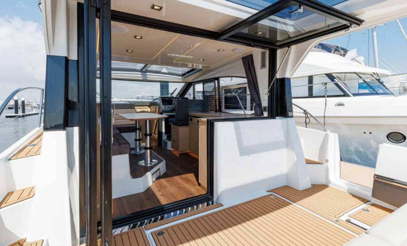
リアドアは折戸タイプ。カウンター窓の上に跳ね上げることで、カウンター以外のスペース全てがオープン。解放感のあるキャビンとテラスのようなアフトデッキがワンフロアになる。アフトデッキを雨から守るイブスにはフィックスのクリアグラス。デッキやキャビンを明るく照らす。サイドゲートは広く、乗り降りしやすいだけでなく、大型魚のランディングもしやすい。
