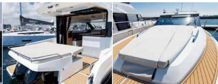
バウ側から見ると、エンジンカバーではなく、ソファとサンタンベッドが設置されたサロングルーザーのトランサムにしか見えない。ソファの背もたれを利用し、サンタンベッドを広くするアイデアも機能的。バウデッキにもサンタンベッド。センターのクッションを外せば、バウキャビンのスカイハッチが現れる。
