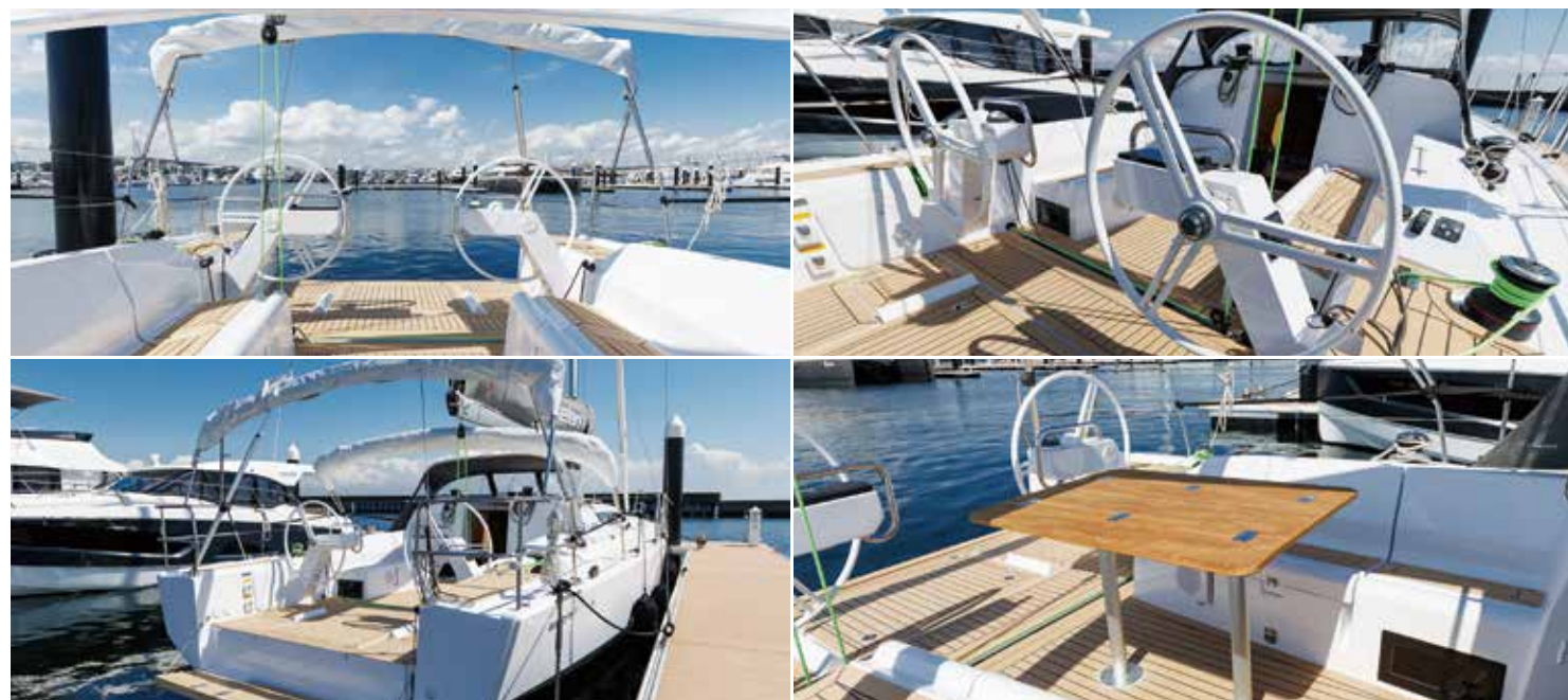
ワイドでフラットなオープントランサムのアフタデッキ。トランサムの一部を開くとスイミングプラットフォームが現れる。コクピットも広く、センターにはチークトップのコクピットテーブルをセットすることができる。
