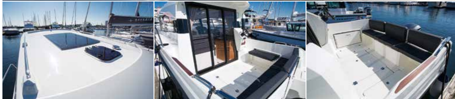
全長の割に広いアフトデッキの秘密は、センターの背もたれ。船外機のチルトアップ時にはバウ側に倒すことができる。トランサムを船外機のすぐそばまで下げることができ、アフトデッキの前後長を広げることができた。
