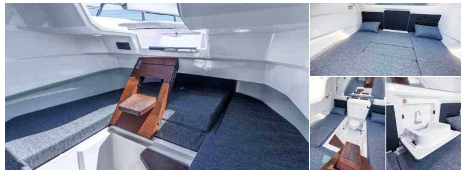
パウのベンチソファを跳ね上げてエントリーするパウキャビン。クイーンサイズのベッドクッションを上げると、このキャビンに出入りするためのステップが収められている。同時に電動マリントイレが現れ、さらに背面を倒せば手洗い用のワイドなシンクが現れる。
