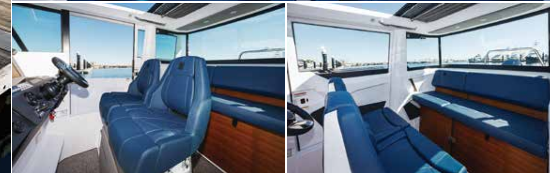
視認性の高いワイドなヘルムステーション。フリップアップのついたボルスターシートをスライドさせ、ステアリングホイールのチルトを調整すれば、カーライクなドライビングポジション。長時間のクルージングでも疲れない。前席は横や、後ろに向けることもでき、横に向けてサイドドアを開けば、格好の釣り座になる。
