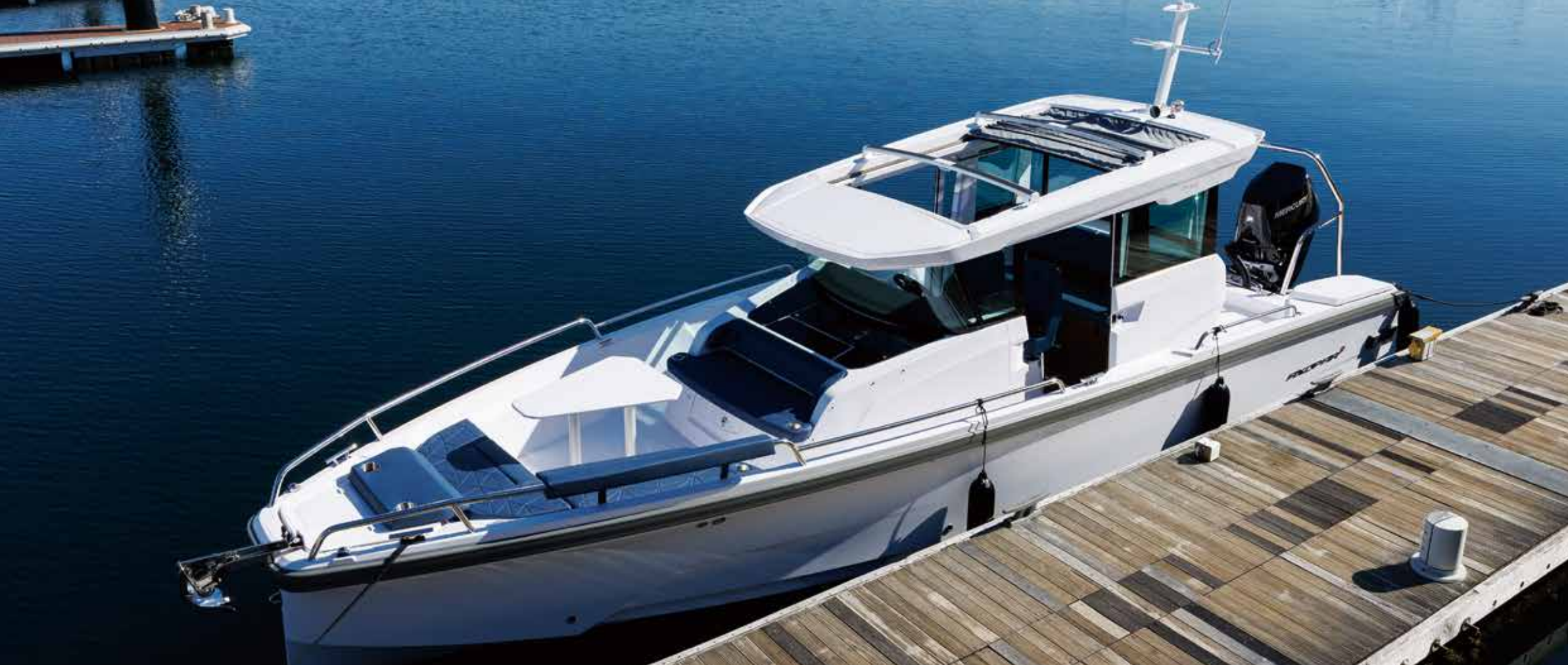
AXOPAR 28 Cabinに比べ、わずかに膨らみを増したAXOPAR 29 XC。容積を増したキャビンのルーフには、最大1,370mm x 1,220mmの広さでオープンするサンルーフ。サイドスライドドアも開ければ、オープンボートの開放感を味わうことができる。ワイドでソフトなサンルーフだが、40ノット以上でも風でバタつくことはない。さらにカバーも用意されている。
