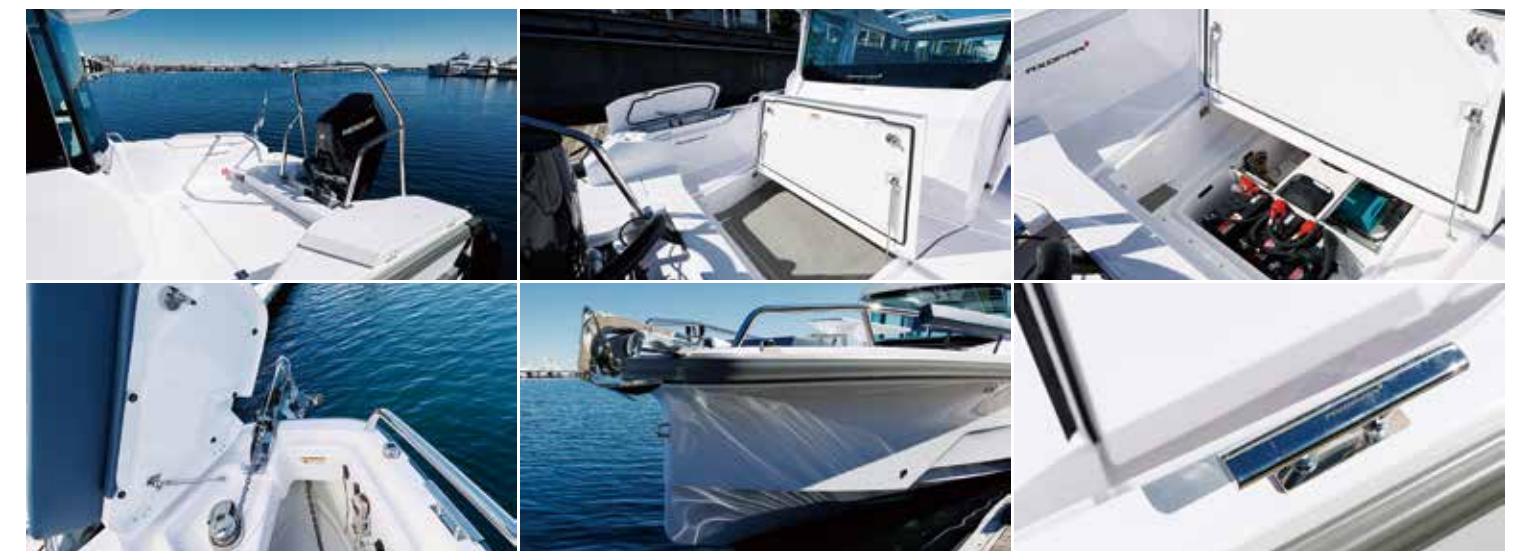
オープントランサムとワイドなスイミングステップが、アフトデッキを広くする。アフトデッキのフロアには長尺物も収められる大きなストレージ。ストレージのフロアの下にはバッテリーが収められ、整備性が高い。アンカーロッカーはクッションを外さず開閉でき、QUICKのウィンドラスを装備。パウのボトムには波を適切にさばく新設計のチェーン、AXOPARロゴが刻まれたクリートも誇らしげ。
